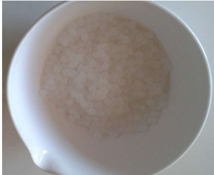
Figura 3.3.- Gránulos de alginato húmedos obtenidos tras el proceso de biosorción de Pb (II) en agua Milli-Q.
