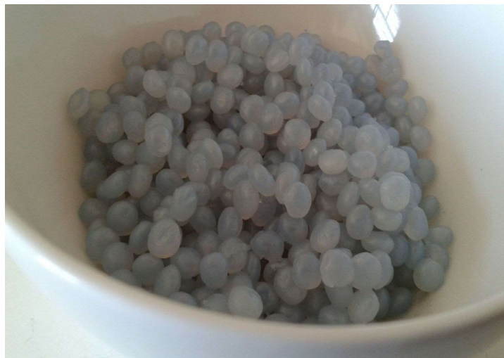
Figura 3.4.- Gránulos de alginato húmedos obtenidos tras el proceso de biosorción de Cr(III) en agua Milli-Q.
