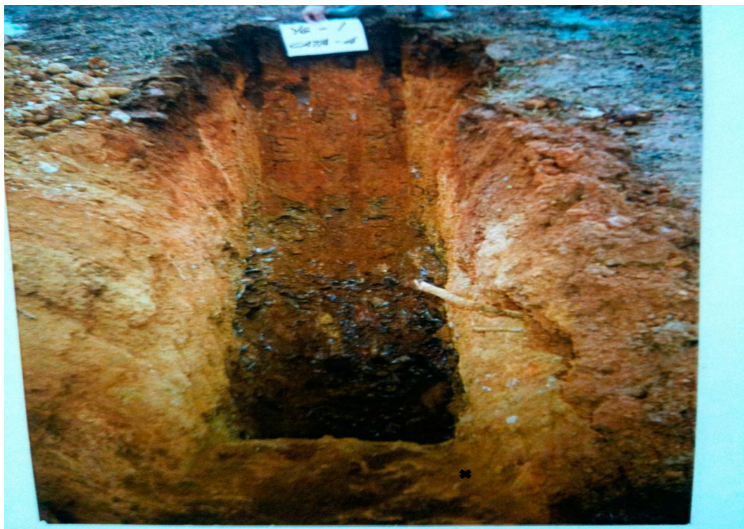
Imagen 6. Calicata mediante retroexcavadora.
