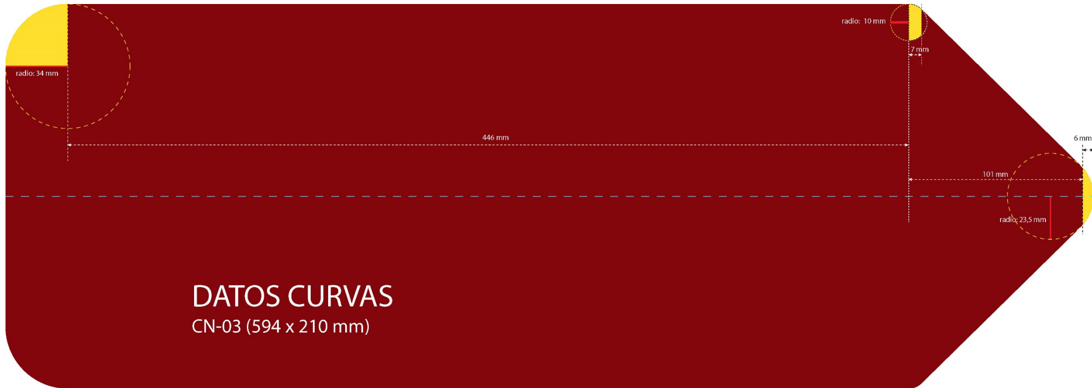
Imagen 2. Dimensiones de la placa CN-03. Fuente: Manual de Señalización de Caminos Naturales
