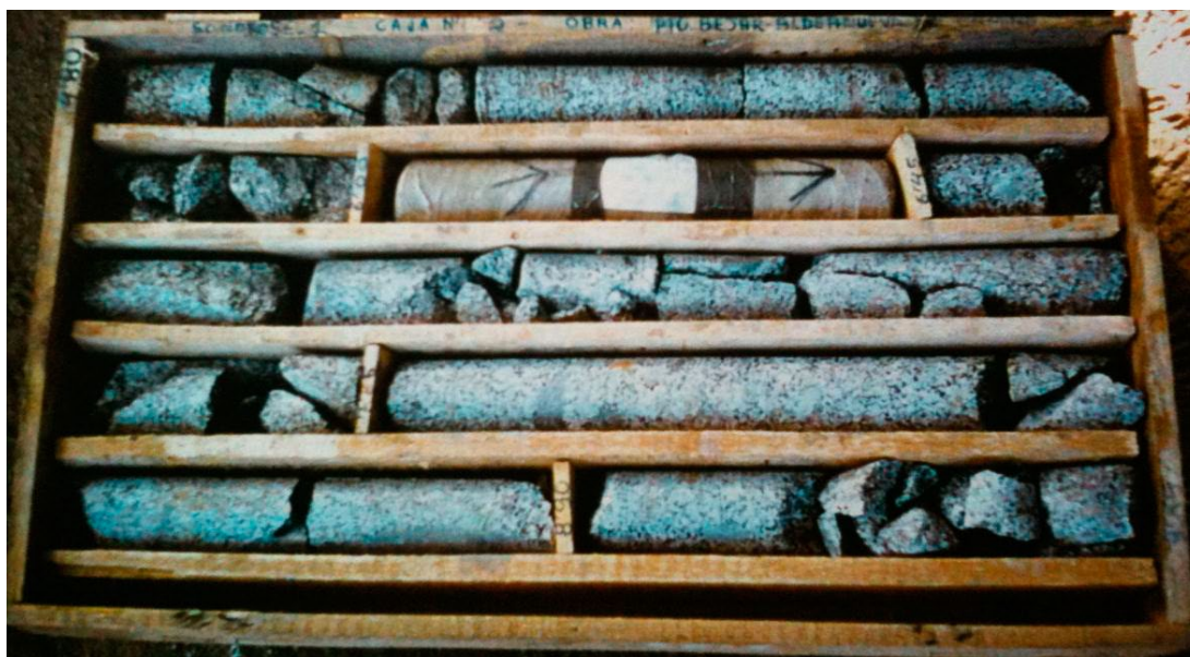
Imagen 9. Ejemplo caja de sondeos obtenida después de realizar los distintos ensayos.
