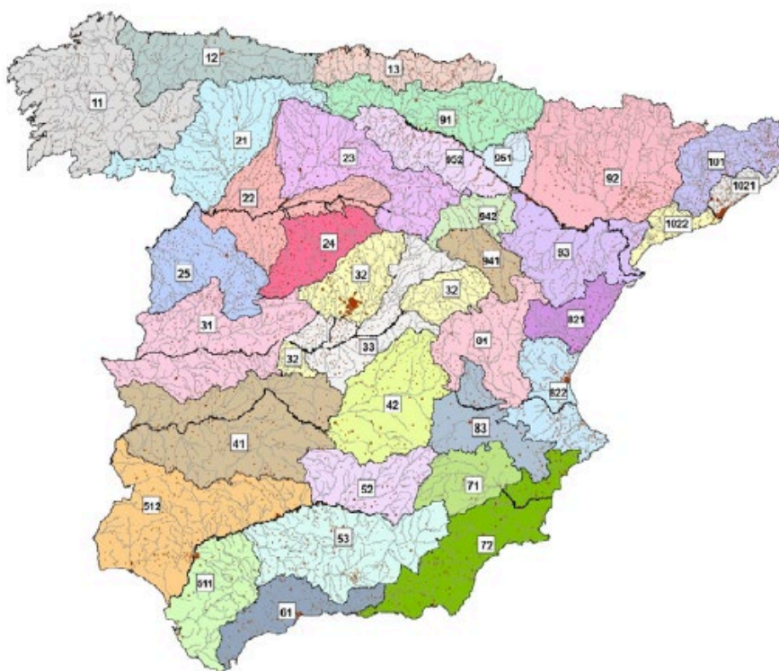
Imagen 11. Regiones para la caracterización del coeficiente corrector de eP_o^i . Fuente: figura 2.9. de la normativa 5.2.I.C.
