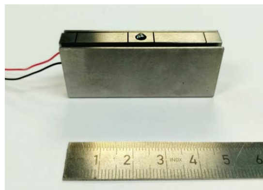
Figura 1: Aspecto de un actuador piezoeléctrico amplificado con carcasa protectora
