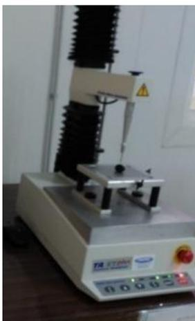
FIGURA 4.3.9 Texturómetro. (Fuente: elaboración propia).
