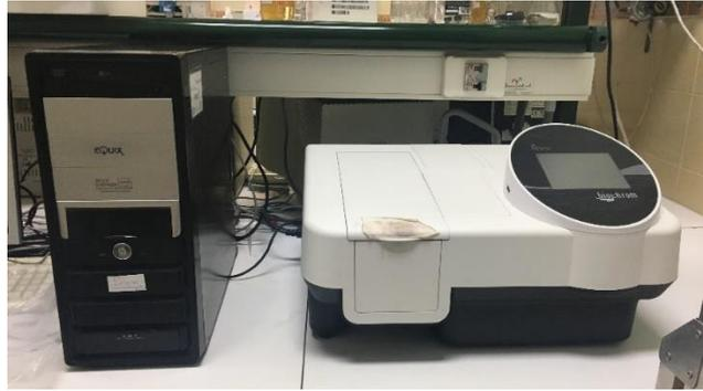
FIGURA 4.3.5 Espectrofotómetro. (Fuente: Laboratorio de investigación, Escuela de Ingenierías Agrarias).
