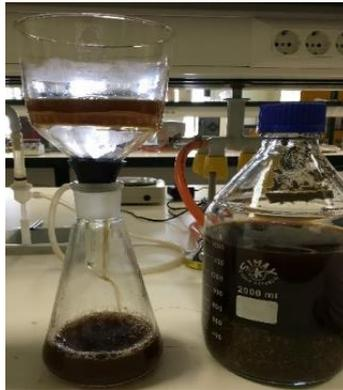
FIGURA 4.2.2 Obtención del extracto acuoso mediante filtrado a vacío.
