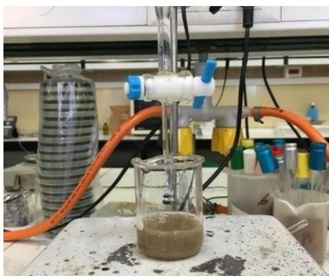
FIGURA 4.3.3 Determinación de cloruros del extracto.
