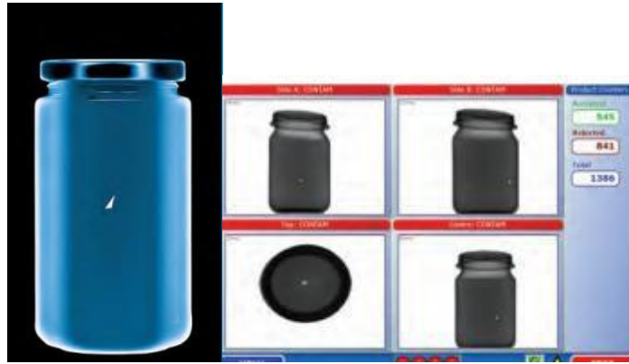
FIGURA 6.12. Equipo de Rayos X detecta un fragmento muy pequeño de vidrio.
