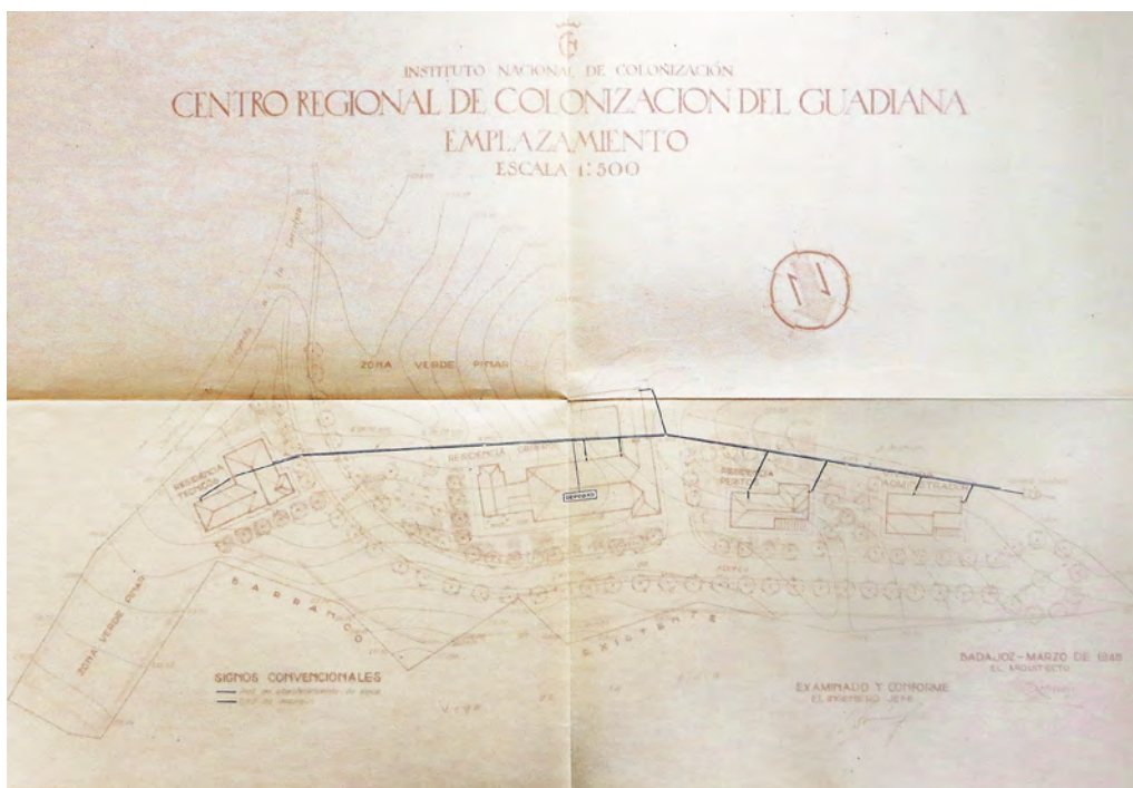
Figura 13. Centro Regional de Colonización del Guadiana. Emplazamiento con la señalización de la red de abastecimiento de agua y red de desagüe (1946). Archivo CEA. Mérida.
