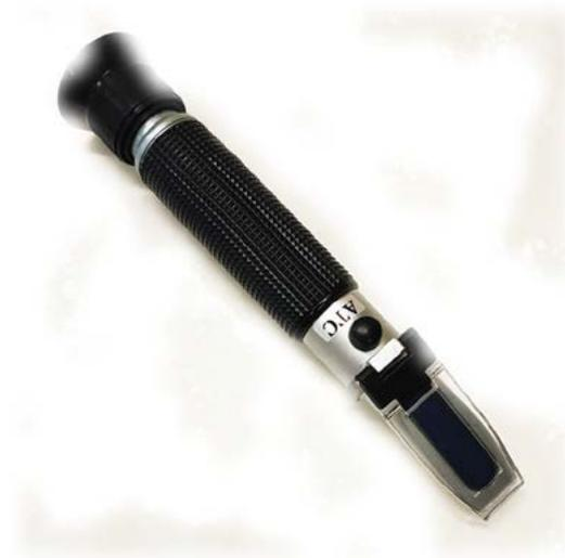
**Figura 5.** Refractómetro utilizado para la determinación de la densidad en la orina.
