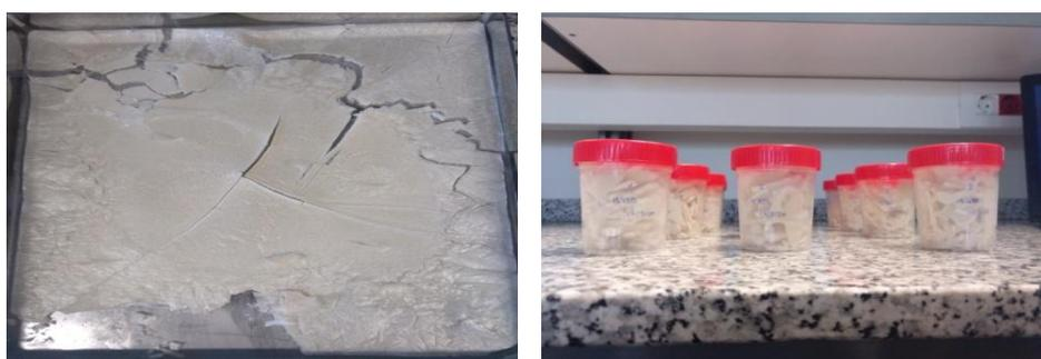
FIGURA 4. 1. De izquierda a derecha: bagazo liofilizado en bandeja y bagazo liofilizado envasado para su posterior uso en la investigación. (Fuente: Elaboración propia)
