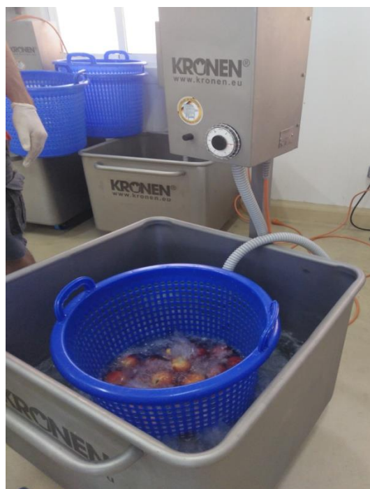
Figura 4.1. Equipo Hrydro-cooling DS1000 MÓVIL de la marca comercial KRONEN para la limpieza y desinfección de la fruta.
