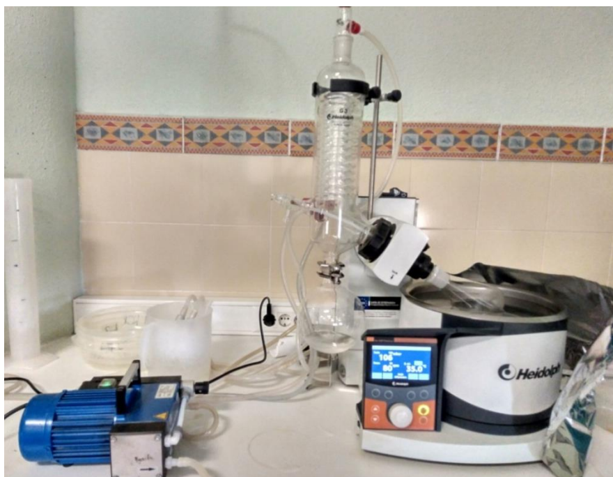
Figura 4.6. Rotavapor Heidolph LABOROTA 4000 usado en la extracción de patulina.
