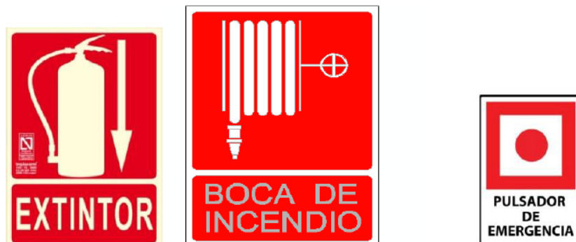
Figura 38. Señalización de elementos de protección contra incendios.
