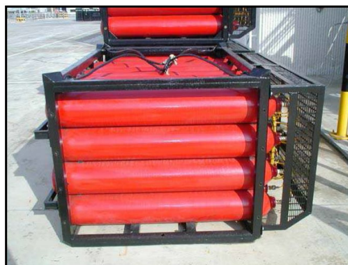
Figura 7. Botellas de almacenamiento de hidrógeno en estado gaseoso. Fuente: Ariema
