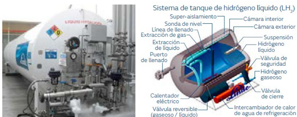
Figura 8. Tanques de hidrógeno líquido. Fuente: Linde Group
