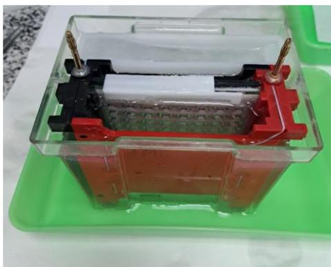
**Figura 16.** Laboratorio Área Bioquímica y Biología Molecular Universidad de Extremadura cubeta perteneciente a la realización de la técnica Western Blot junto con sándwich y transfer buffer con bloque de hielo.
