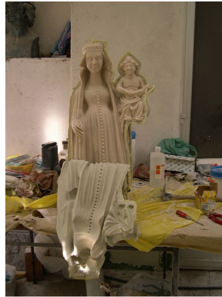
Imagen 2. Apertura del molde de silicona con la pieza de resina en su interior.
