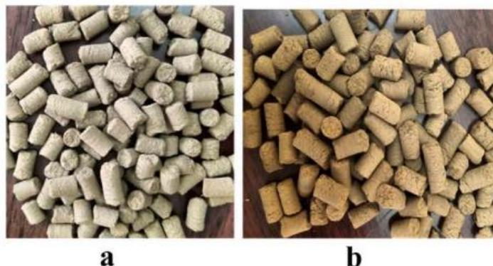
El uso de pellets en procesos de combustión de biomasa presenta varias ventajas. Los pellets ofrecen una forma densificada y de fácil manipulación de la biomasa, facilitando su almacenamiento y transporte. Además, su tamaño uniforme y contenido de humedad controlado contribuyen a una combustión más eficiente. La peletización también brinda la posibilidad de aprovechar una variedad de fuentes de biomasa para la generación de energía, promoviendo prácticas más sostenibles[116]
