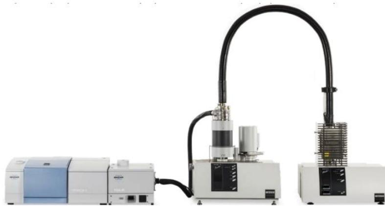
La figura 50 muestra la Termobalanza acoplada al espectrómetro de masas usada para este ensayo.
