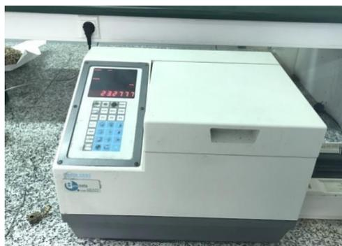
Figura 49 Esquema de la bomba calorimétrica
