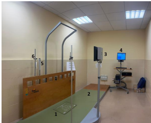
Figura 19. Equipo completo. 1: Plataforma, 2: Tarima, 3: Monitor para el paciente, 4: Ordenador especialista, 5: Tallímetro, 6: Barreras de fotocélulas.
