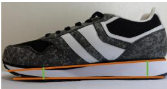
Figura 4. Cómo calcular el drop. Diferencia entre la altura de la suela del retropié y antepié.
