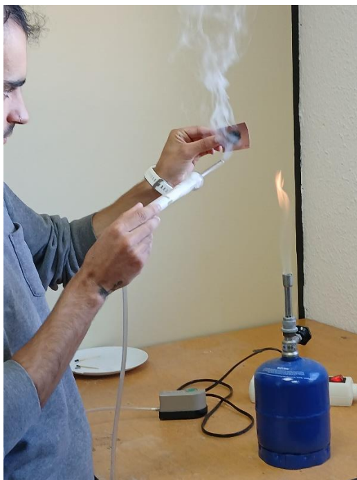
Fig 15: Método de aplicación del cloruro de amonio sublimado a través de un tubo de vidrio.
