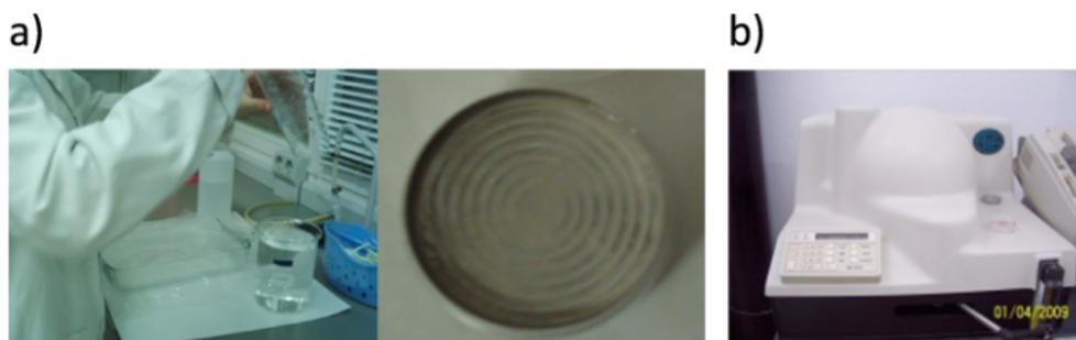
Figura 1. a) Fotos del proceso de elaboración para la determinación de los índices de actividad alfa total y beta total. b) Contador proporcional de flujo de gas.
