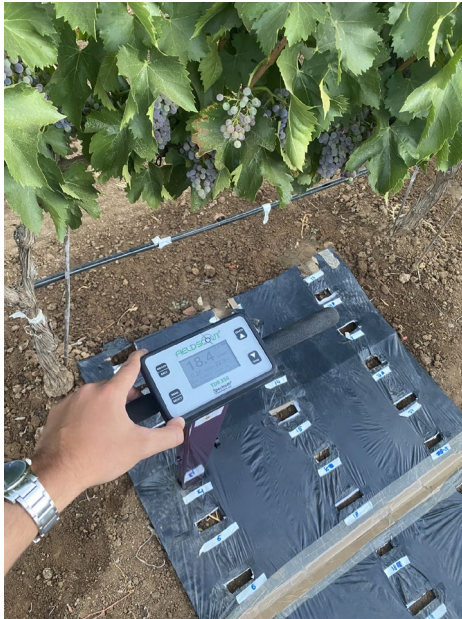
Figura 19. Sensor FieldScout TDR 350 (Spectrum Technologies, Inc., Aurora, IL, USA) midiendo en campo la fracción humedecida (fw) del suelo por cada tratamiento de riego (fuente: elaboración propia).
