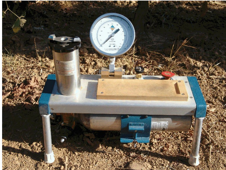
Figura 35. Medidor de potencial hídrico tipo Scholander (Soil Moisture Corp, Santa Bárbara, California, USA) (fuente: elaboración propia).
