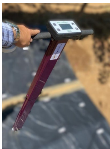
Figura 12. Sensor FieldScout Time Domain Reflectometry (TDR) 350 (Spectrum Technologies, Inc., Aurora, IL, USA) (fuente: elaboración propia).
