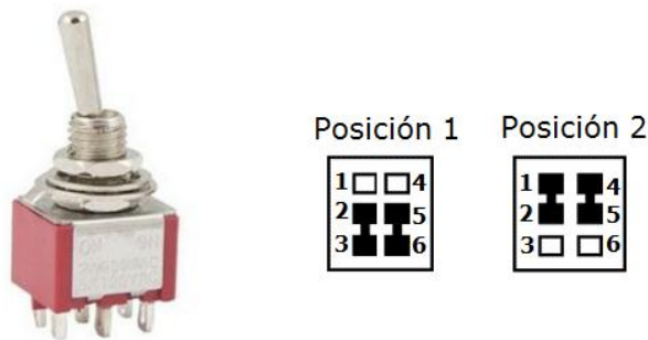
Ilustración 53. Switch DPDT utilizado para la conmutación y estados que puede tomar.
