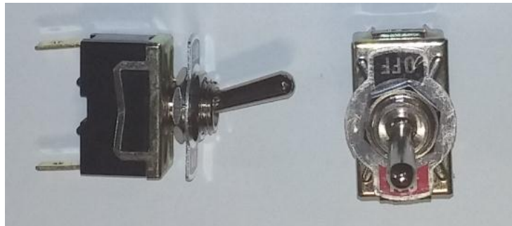
Ilustración 56. Vista del interruptor de “stand by”.
