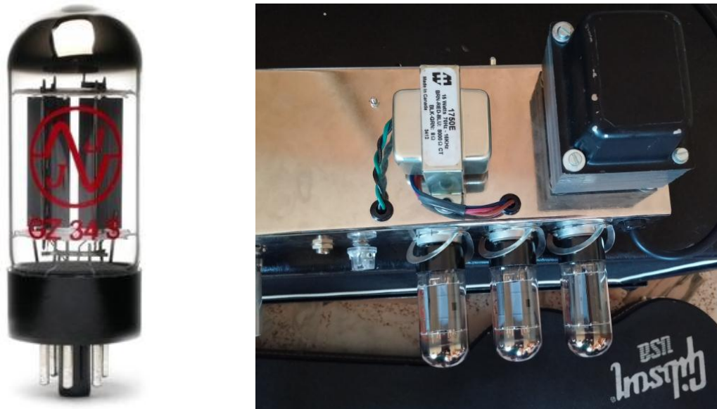
Ilustración 17. Válvula rectificadora 5A4R utilizada en el proyecto.
