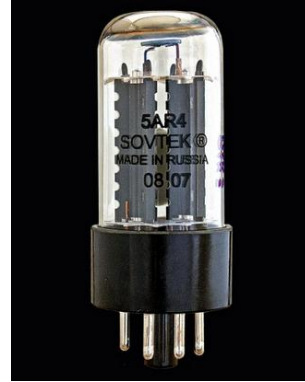
Ilustración 31. Válvula rectificadora de fabricación rusa: Sovtek 5AR4.
