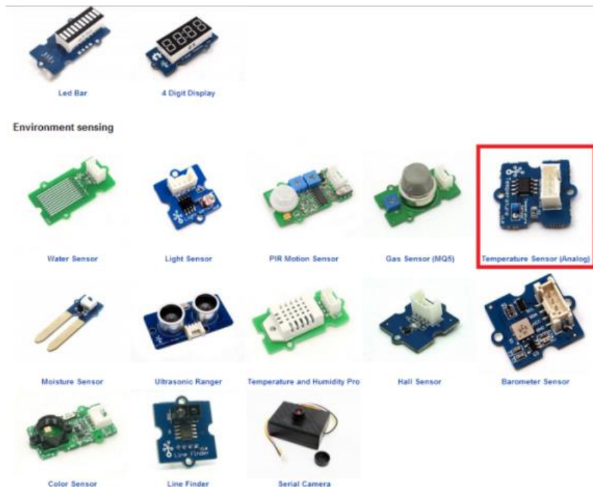
Figura 10: Algunos de los sensores/actuadores compatibles con OpenPicus.
