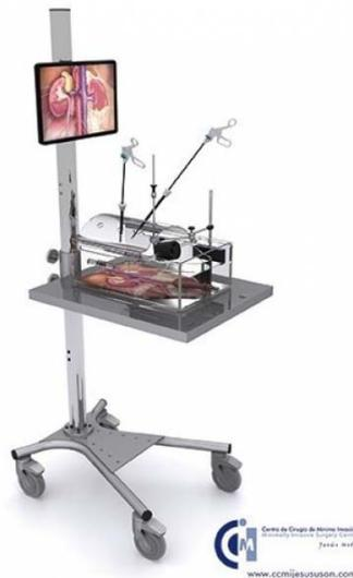
**Figura 3.6: Equipo de simulación completo (SIMULAP® + CARROLAP®) desarrollado en CCMIJU.**
