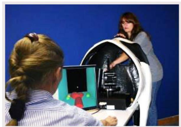
Figura 4. Simulador háptico para la exploración ginecológica de la vaca, desarrollado por Geomatic© (Baillie, Mellor *et al.* 2005).
