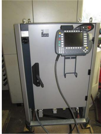
**Figura 2.4** Controlador KUKA KR C 2.
