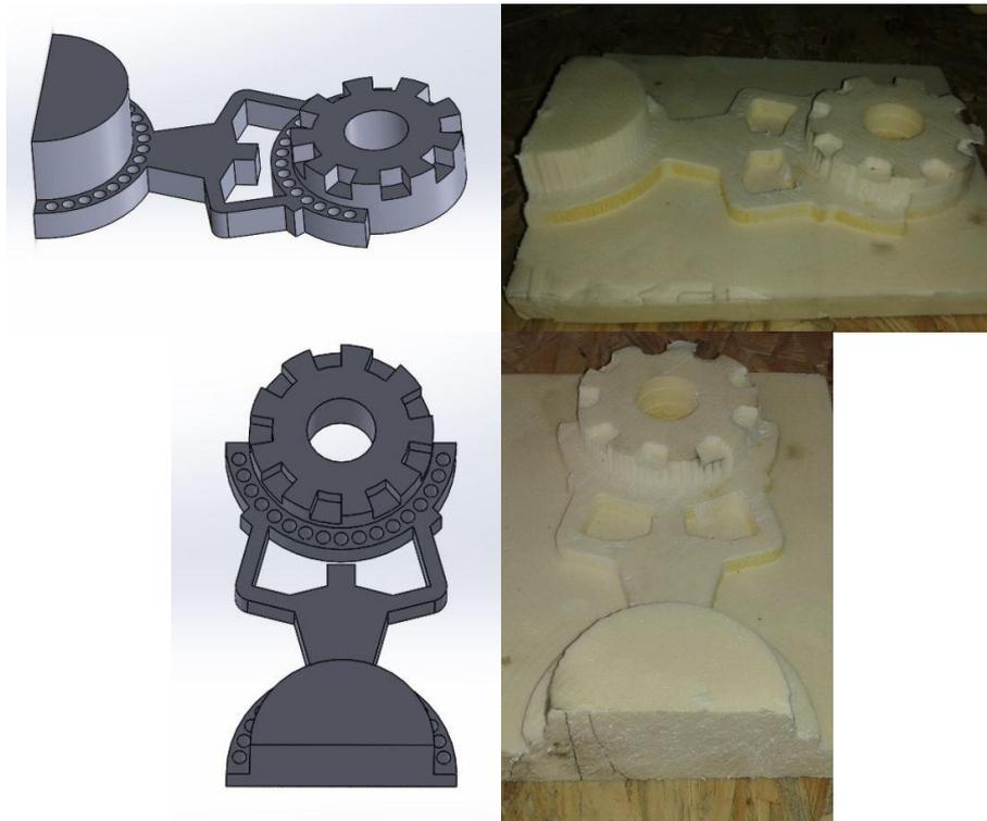
**Figura 4.1** Ensayo de fresado 1.
