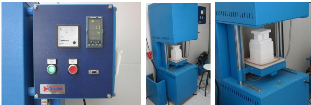
Figura 2. 10 Horno Thermolab empleado en la sinterización de scaffolds.
