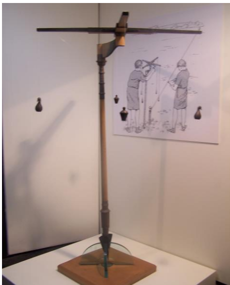
Foto 43 Reconstrucción de una Groma. Museo Boscoreale. Fuente: M. Fraile
