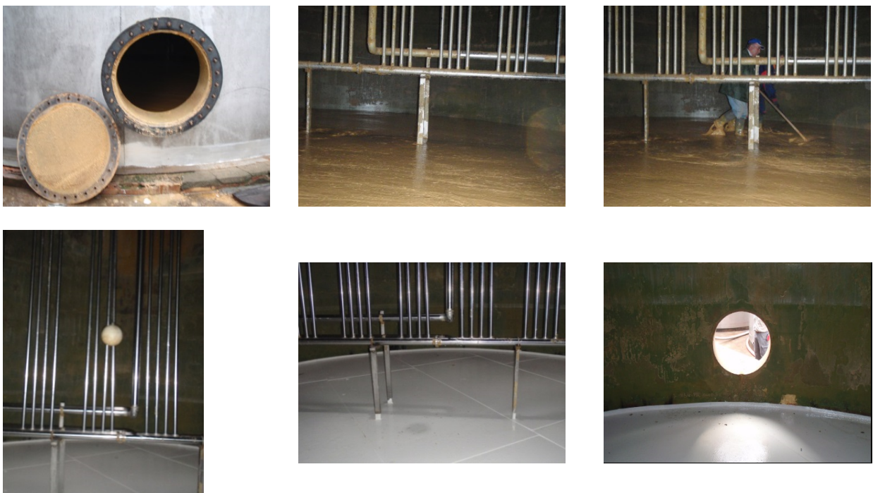
Figura 6.53. Tareas de limpieza en depósitos de almacenamiento donde se produce la fermentación del vino blanco.
