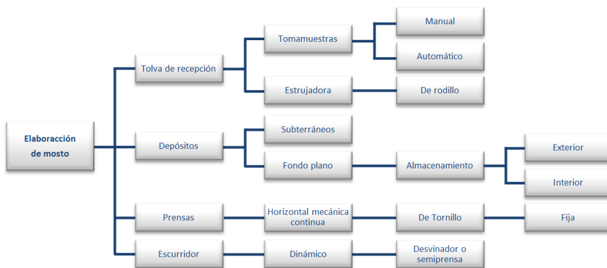
Figura 5.4. Maquinaria y equipos para el proceso de elaboración de mosto.
