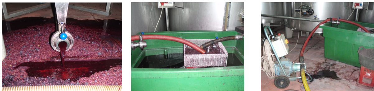
Figura 6.21. Imágenes correspondientes a un descube de depósito de maceración de fondo plano.
