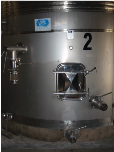
Depósito de desfangado.
