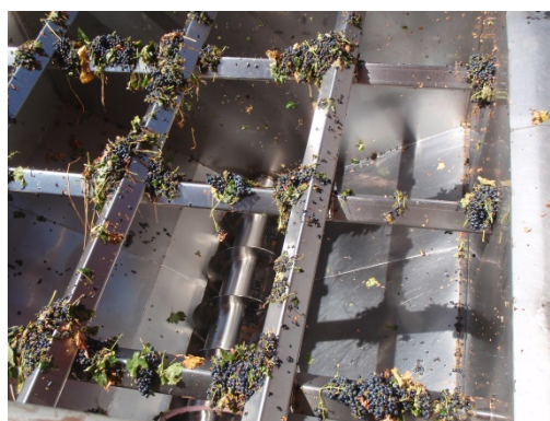
Tolva de descarga y sinfín.
