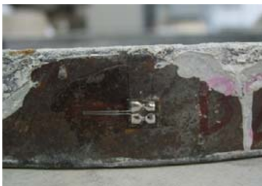
Figura 5.8 Galga para el registro de deformaciones en los anillos interior y exterior.
