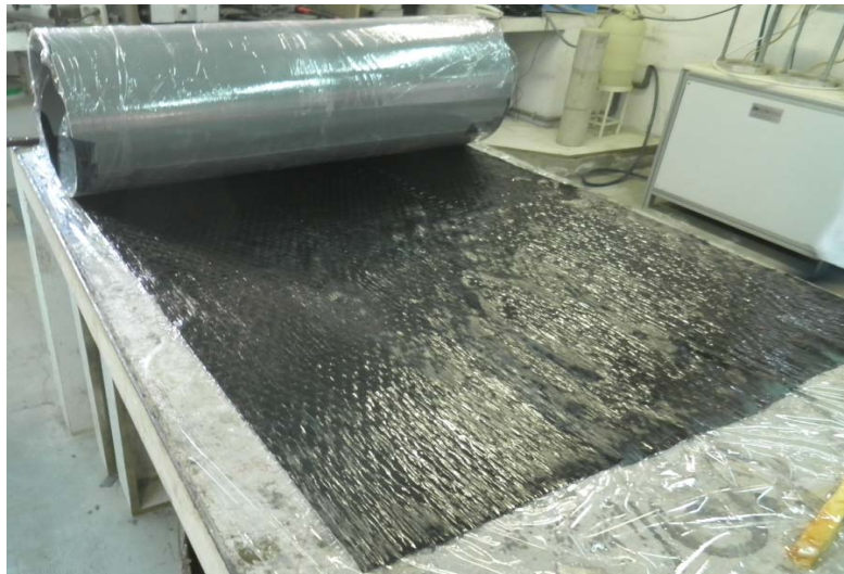
Figura 6.11 Fabricación de encamisados exteriores de CFRP, paso 1.
