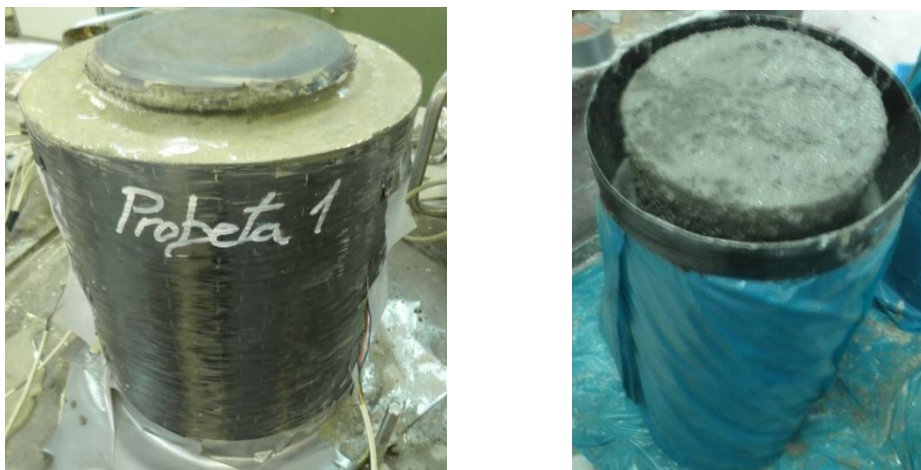
Figura 6.14 Ejecución de refuerzo indirecto por Vertido y llenado del espacio entre camisa CFRP y elemento a reforzar, tipo probeta (izquierda) y tipo pilar armado (derecha).
