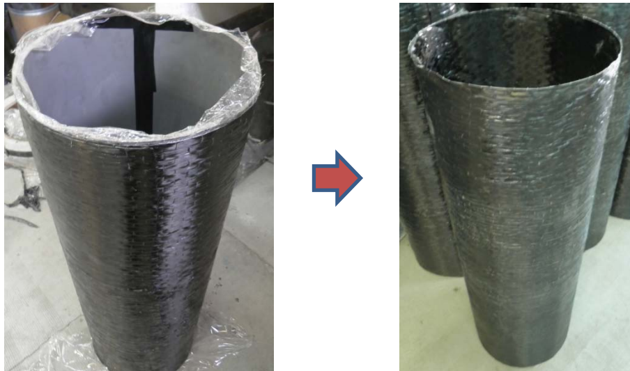
Figura 6.13 Fabricación de encamisados exteriores de CFRP. Curado (izquierda) y desmoldado (derecha).
