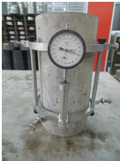
Figura 3.11 Probeta cilíndrica instrumentada con compresómetro ASTM C469.
