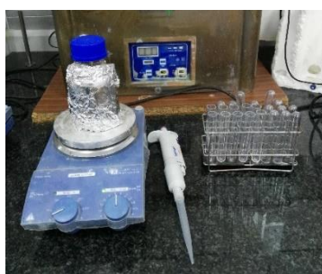
Figura 3.4. Instalación experimental para los experimentos de oxidación con reactivo Fenton
