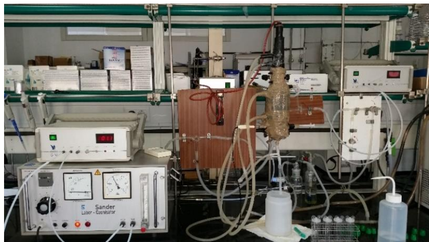
Figura 3.3. Instalación experimental de los experimentos de fotodegradación y de ozonización.
