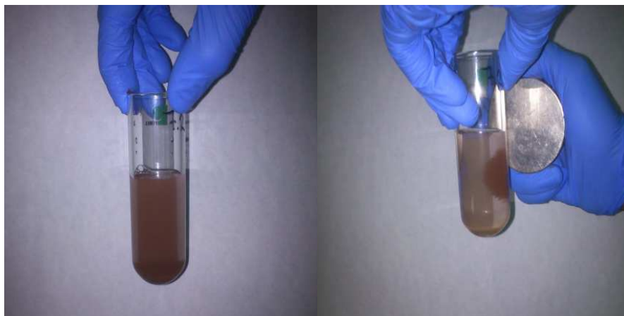
Figura 8.21. Retirada de CAT3.2 con ayuda de un imán.
