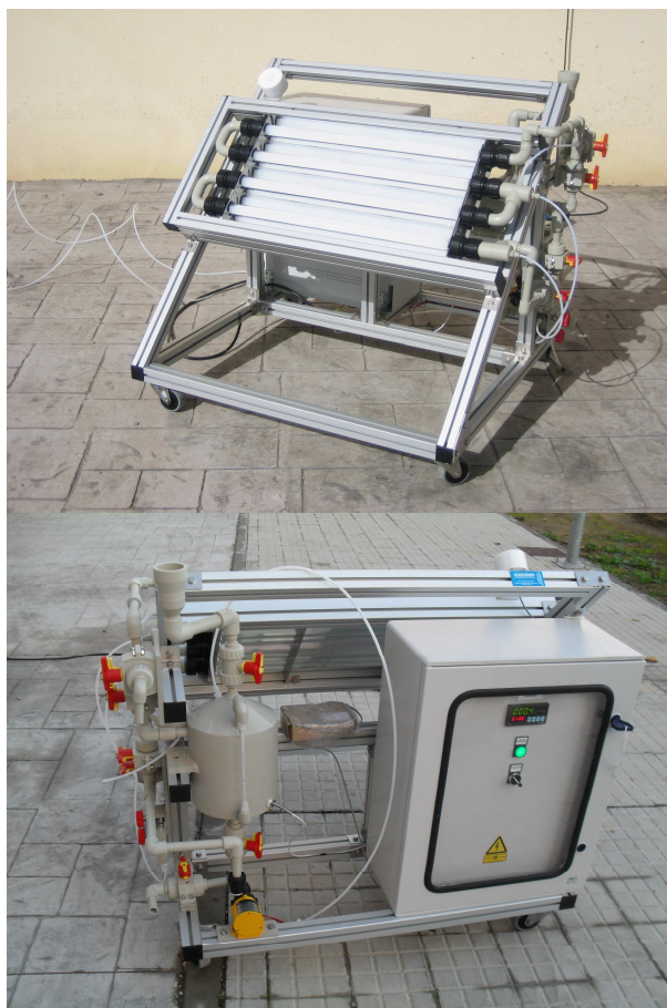
Figura 7.3. Fotografía del reactor CPC diseñado para el empleo de ozono.
