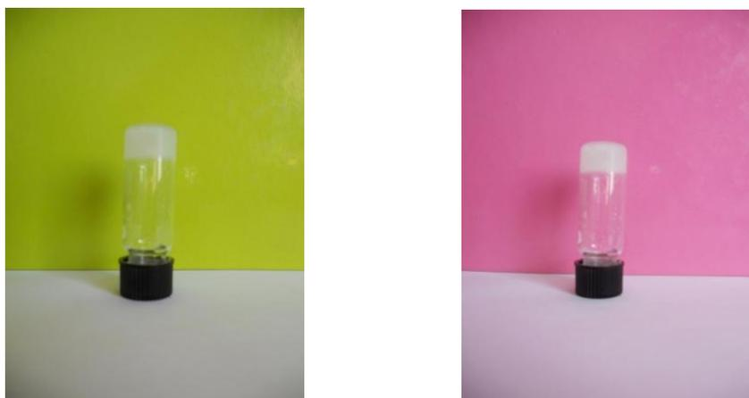
**Figura 3.5.3.** Gelificación de los compuestos **20** y **21** (test del tubo invertido) en DMSO al 4% y 3% en peso, respectivamente.
