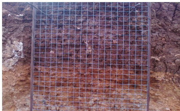
Figura 3.2. Malla metálica empleada para la determinación de la profundidad máxima del sistema radicular.
