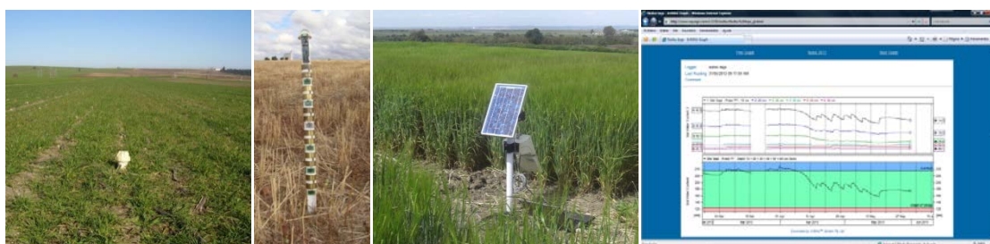
Figura 3.3. Sistema de monitorización del agua en el suelo y panel online de visualización de la información.
