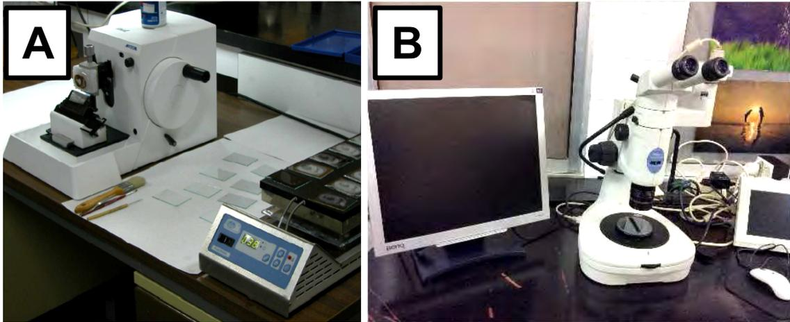
**Figura 37.** A: Imagen del micrótopo de rotación Microm HM 340 E y plancha Selecta para el estiramiento y secado de los cortes. B: Imagen del estereomicroscopio provisto de una cámara digital Nikon SM 1500.
