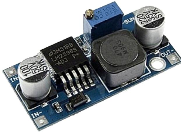
Figura 3.5 Conversor de voltaje DC-DC Step - Down LM2596.
