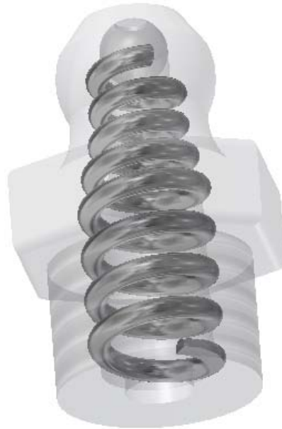
Figura 5.115: Ilustración de montaje y aplanamiento de la parte inferior del muelle del engrasador.
