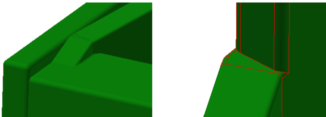
Figura 5.108: Ajustes para un buen ensamblado en la estructura de las ruedas.
