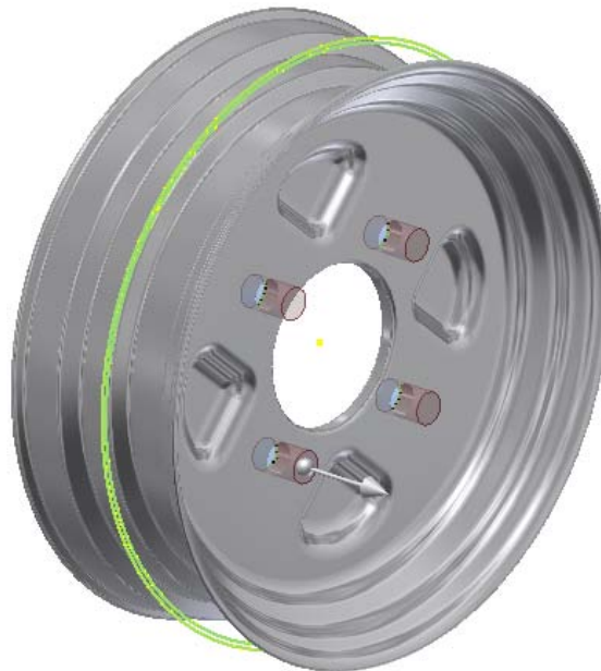
Figura 5.59: Realización de las perforaciones para los tornillos en la llanta.
