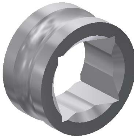
Figura 5.88: Modelo paramétrico de la corona interior de uno de los cojinetes de bolas.
