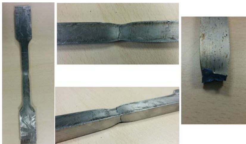
Figura 7.6: Imágenes de la probeta tras el ensayo de tracción.
