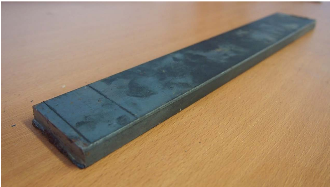
Figura 7.2: Muestra base sobre la que se mecanizó la probeta de ensayo.
