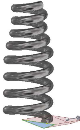
Figura 5.32: Extrusión para conseguir una cara plana en el muelle.
