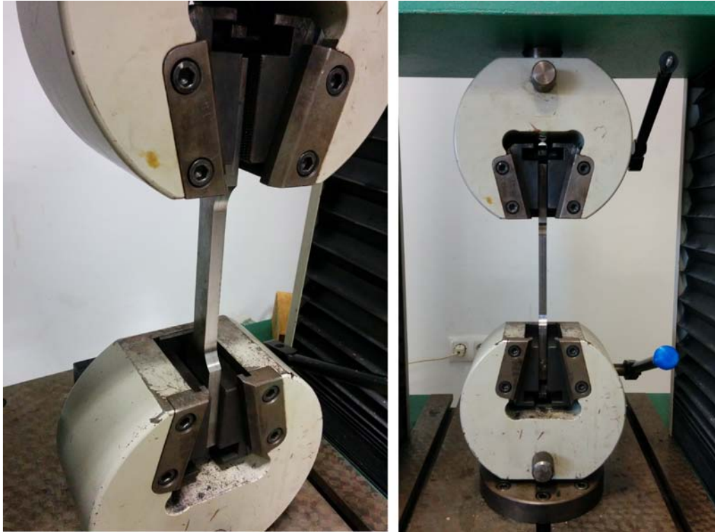
Figura 7.4: Disposición de la probeta en la máquina de tracción.
