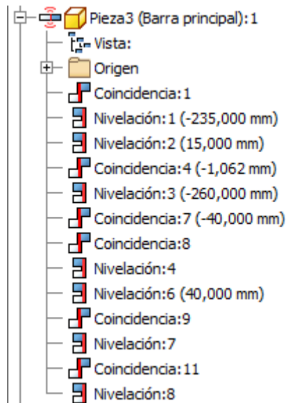
Figura 5.106: Restricciones sobre la barra principal.
