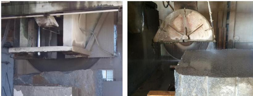
Figura 1.16. Corte con cortadoras de disco
