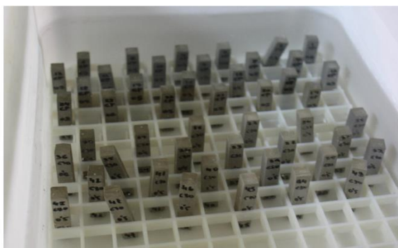
Figura 8.1. Probetas fabricadas y expuestas a la disolución de sulfato sódico
