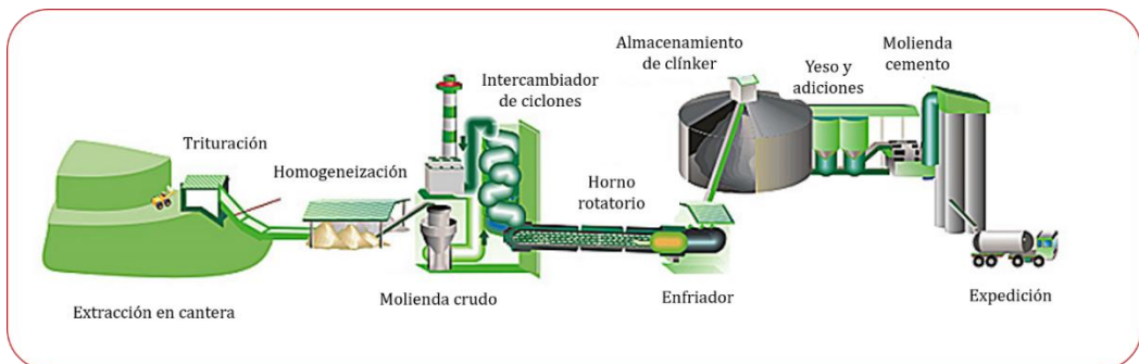
Figura 1.3. Proceso de fabricación del cemento
