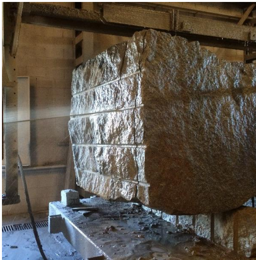
Figura 1.15. Bloque escuadrado. Proceso de corte
