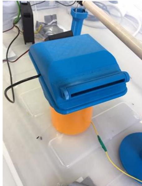
Figura 4: Dispositivo humidificador impreso en 3D.
