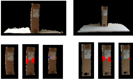
Figura 2: Escena con nubes de puntos des ambas cámaras \mathbf{P}_{O_i} y \mathbf{P}'_{O_i} (arriba) y fases del algoritmo (abajo), en el que de izquierda a derecha se muestra la segmentación, detección de zona candidata de agarre en base a ejes \mathbf{e}_{O_i} y \mathbf{e}'_{O_i} y centros \mathbf{c}_{O_i} y \mathbf{c}'_{O_i} , así como la selección óptima de puntos de agarre \mathbf{p}_{o_c} y \mathbf{p}'_{o_c} dentro de las zonas candidatas en base la métrica diseñada.
