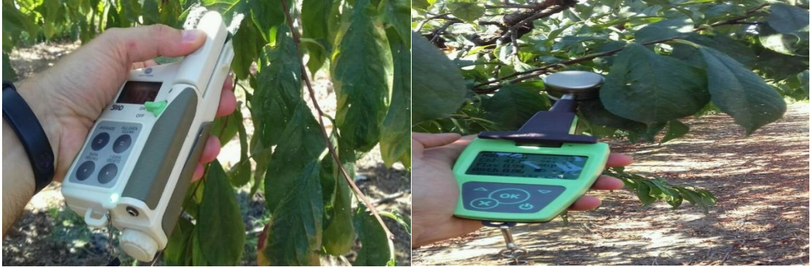
Figura 4.4. a) Detalle de medida con SPAD-502 (Soil Plant Analysis Development, Minolta Camera Co., Ltd., Japan). b) Detalle de medida con Dualox 4.0 (Force-A, Orsay, France) en hoja de ciruelo cv. Red Beaut (elaboración propia)
