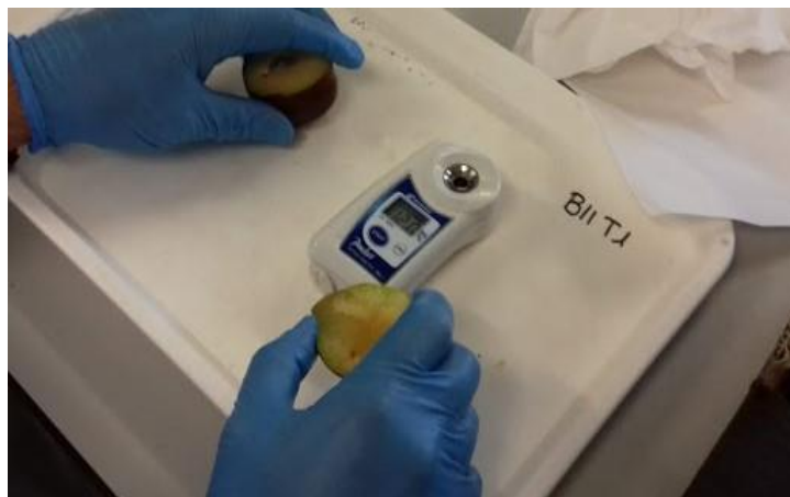
Figura 4.11. Detalle de operación de determinación de contenido de sólidos solubles mediante refractómetro ATAGO modelo Pocket PAL-1 (elaboración propia)
