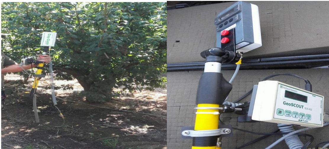
Figura 4.5. a) Detalle de medida con Crop circle ACS-470 (Holland Scientific, Inc., Lincoln, NE) en hoja de ciruelo cv. Red Beaut. b) Detalle del propio aparato (elaboración propia)
