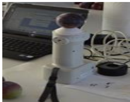
Figura 4.9. Detalle de operación de medida de color con colorímetro espectrofotómetro (Konica Minolta, modelo CM-600d). (Elaboración propia)
