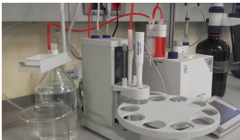
Figura 4.12. Detalle del titrador marca CRISON Titromatic 1S-1B (elaboración propia)
