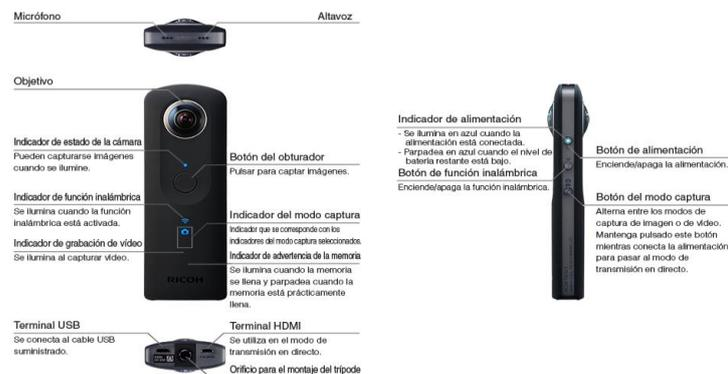
**Ilustración 29: Cámara 360° Ricoh Theta S<sup>57</sup> (fuente: theta360)**
