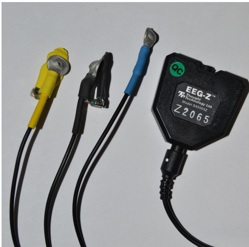
Ilustración 30: Electrodo de cuchara y sensor para electroencefalograma con control para impedancia. Fuente propia.
