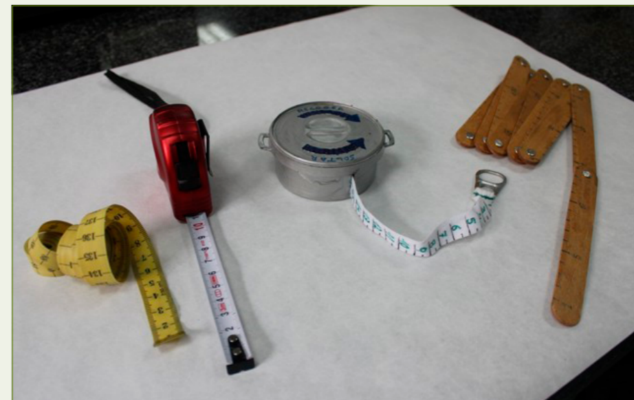
Figura 2.2. Distintos tipos de metros (cinta métrica elaborada por los alumnos de la Facultad de Formación del Profesorado, U. de Extremadura).
