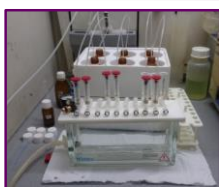
Figura 1. Instalación para la extracción en fase sólida (SPE) y su posterior análisis en HPLC-MS/MS.
