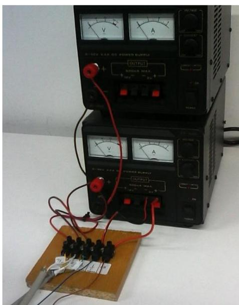
Figura 2.2. Conexión de Fuentes Ep-603 para alimentar distintos elementos del sistema de monitorización multicanal.
