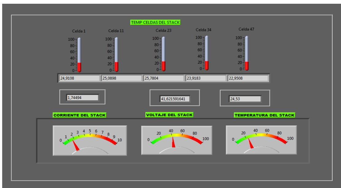
Figura 2.35. Interface de Usuario para el seguimiento de las temperaturas, corriente y presión del H<sub>2</sub> del stack.
