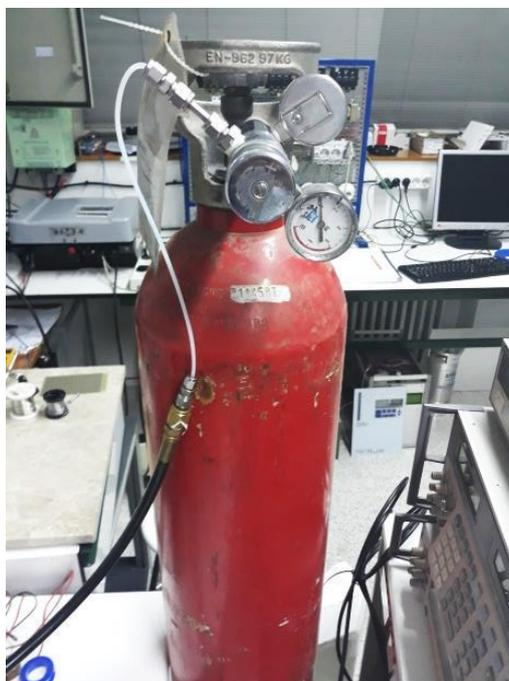
Figura 2.10. Bombona de hidrógeno comprimido utilizada para alimentar stack ballard Nexa 1.2Kw.
