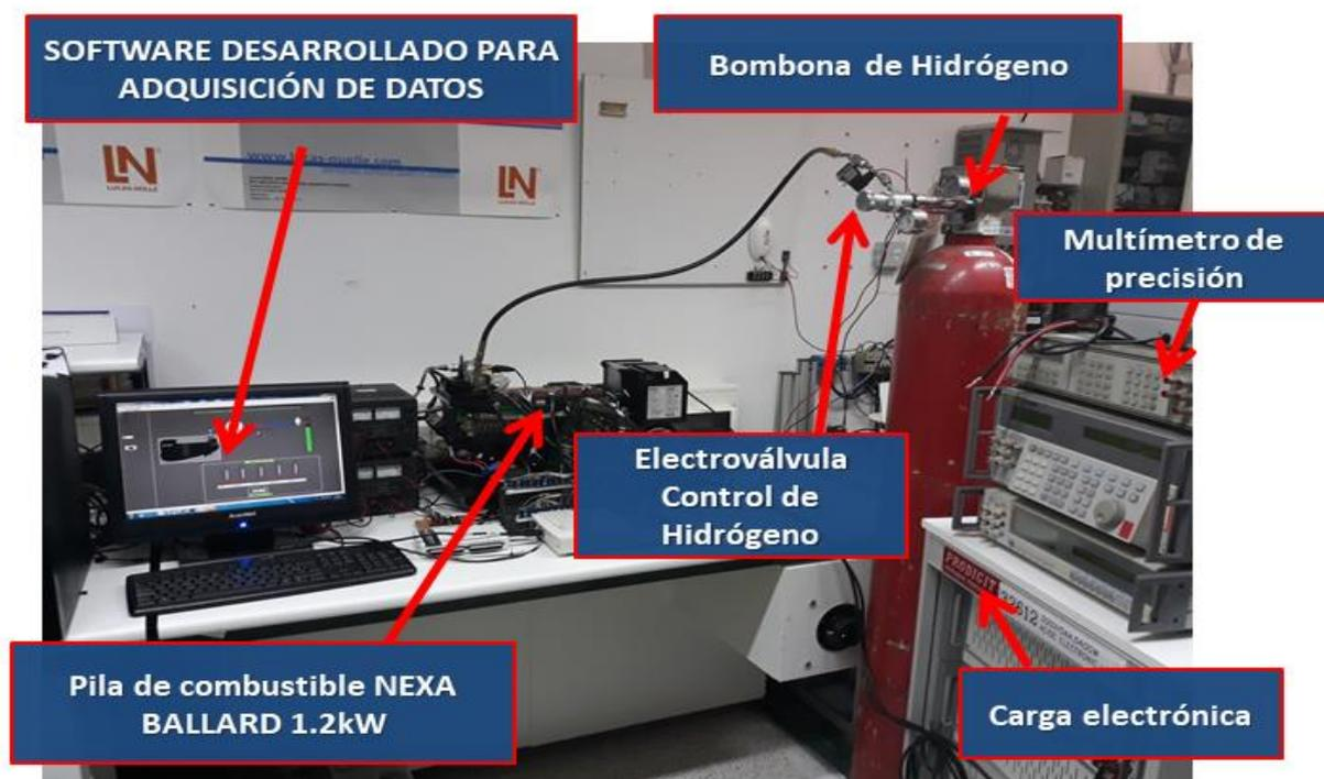
Figura 2.48. Configuración de equipos para ensayos con pila de combustible Ballard Nexa de UEX.
