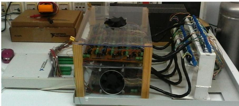
Figura 2.29. Conexión de placas de aislamiento de masas a las salidas de los divisores de tensión y a las entradas analógicas del DAQ NI-USB-6225.
