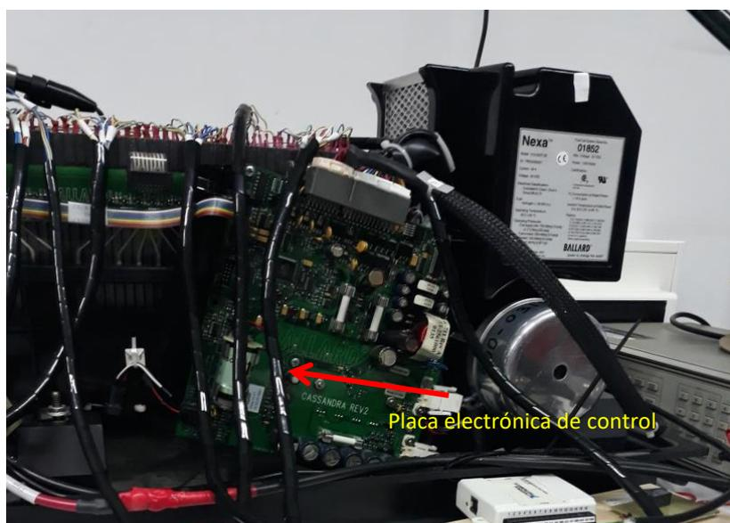
Figura 2.9. Tarjeta o placa electrónica de control de la pila de combustible Nexa.
