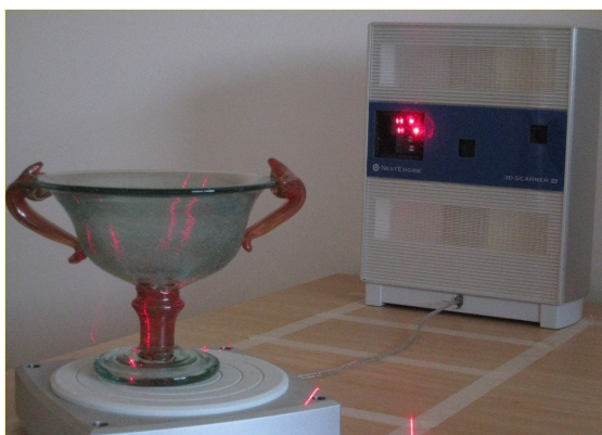
Escaneo de una reproducción de copa de vidrio romana mediante el escáner de escritorio NextEngine.
