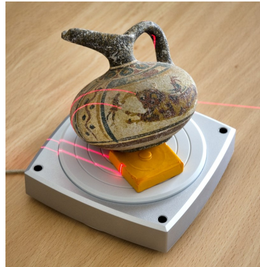
Escaneado en posición oblicua para cubrir zonas no visibles en otras posiciones.
