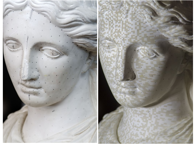
Proyección de un patrón de luz estructurada sobre la superficie del objeto.
