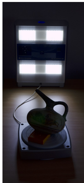
El color se toma con iluminación LED y una cámara interna.
