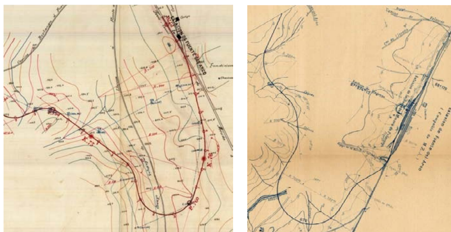
Fig. 4. Comparación entre el proyecto original (AGA 25-07106) y el modificado (AGA 25-07112) en las inmediaciones de la estación de Fuente del Arco. Puede apreciarse cómo la traza presenta variaciones notables
