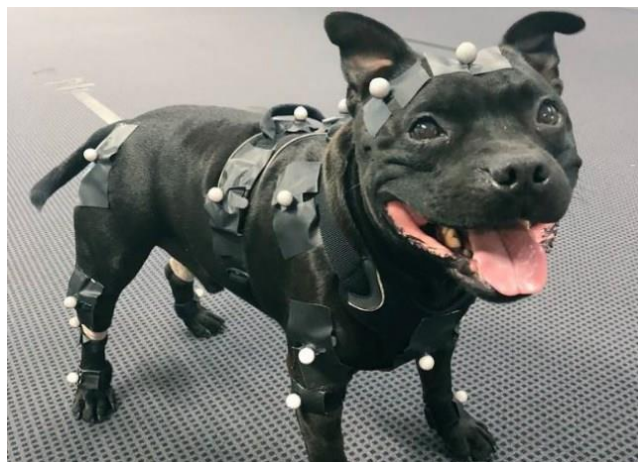
Imagen 19. Perro con bolas de traqueo para hacer la captura de movimiento.
