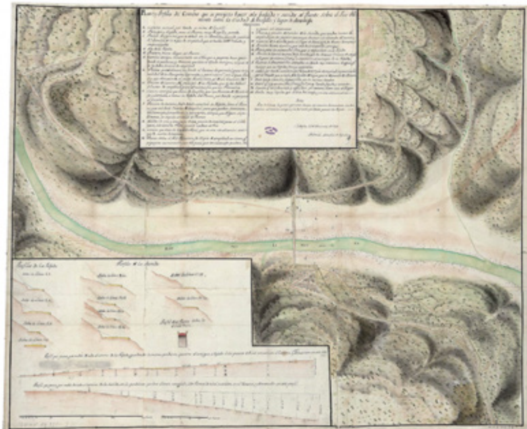
Figura 19. Dionisio Sánchez Aguilera, Plano y perfiles del camino que se proyecta hacer en la bajada y subida al puente sobre el río Almonte, en el camino que une Jarajico con Trujillo . 1764. Tinta y aguada de colores, 770 x 930 mm. Archivo General de Simancas, MPD, 21, 057.
