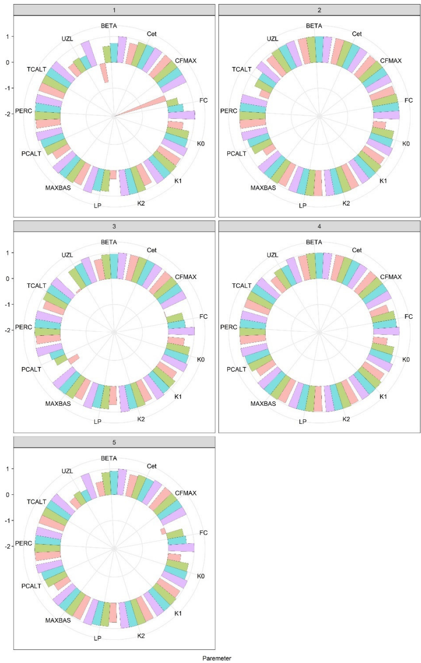
Figura 41. Sensibilidad del modelo a variaciones de los valores de los parámetros calibrados (a) análisis global (b) análisis en clústeres. Los valores de ajuste en torno a 1 implican que el modelo no es sensible a ese parámetro ya que el GoF es tan bueno como los resultados obtenidos por la calibración con la mejor combinación de parámetros.
