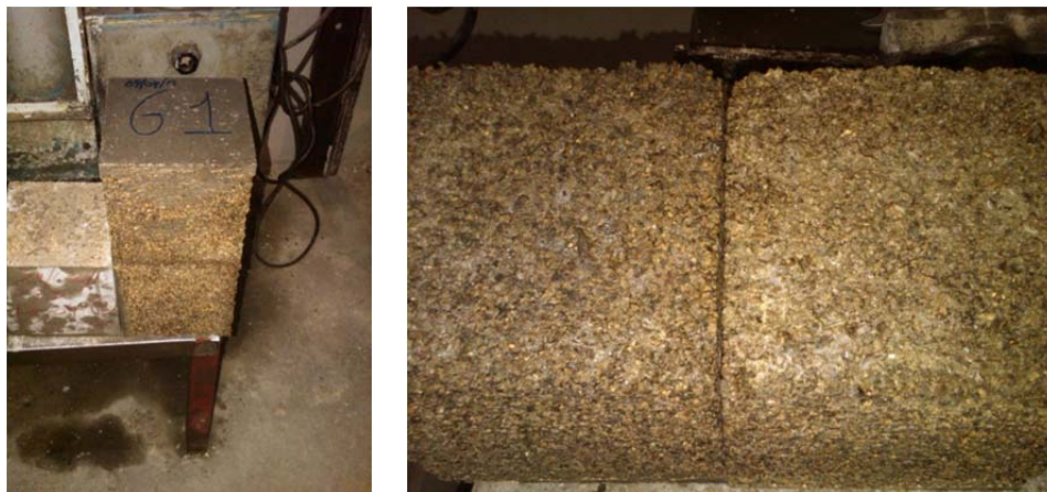
Figura 3.3- Muestras preparadas con agua sometida a fermentación durante 28 días.
