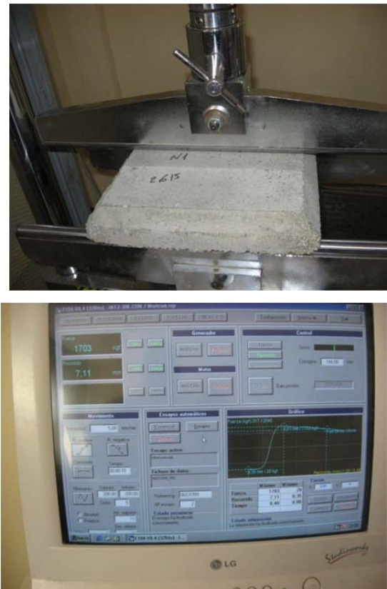
Figura 3.6- Ensayo a flexotracción (izquierda) de baldosa de muestra y gráfica de rotura (derecha).
