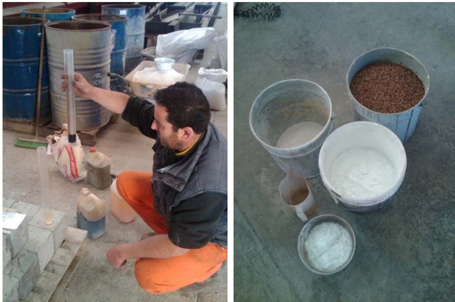
Figura 3.11- Preparación de las dosificaciones de los materiales por familias completas de muestras (Foto cedida Antonio Ruiz).
