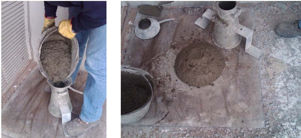
Figura 3.4- Ensayo de cono de Abrams de consistencia fluida (UNE 83-313-90// -EN 12350-2)
