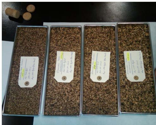
Figura 3.2.- Diferentes granulometrías de corcho empleadas en el estudio.
