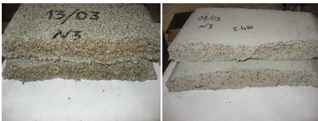
Figura 3.8- Secciones de muestras de distintas composiciones y rotas a flexotracción (Foto Alberto Escalera)
