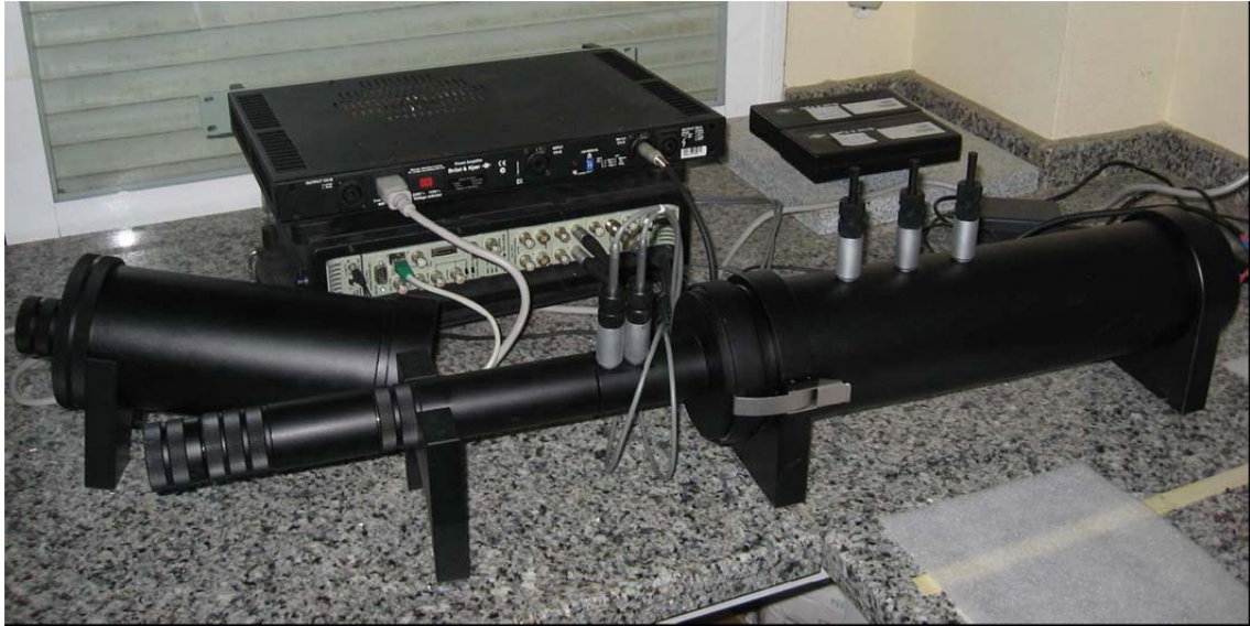
Figura 3.23.- Detalle del tubo de impedancia utilizados en la obtención del coeficiente de absorción, impedancia característica y pérdidas por transmisión.
