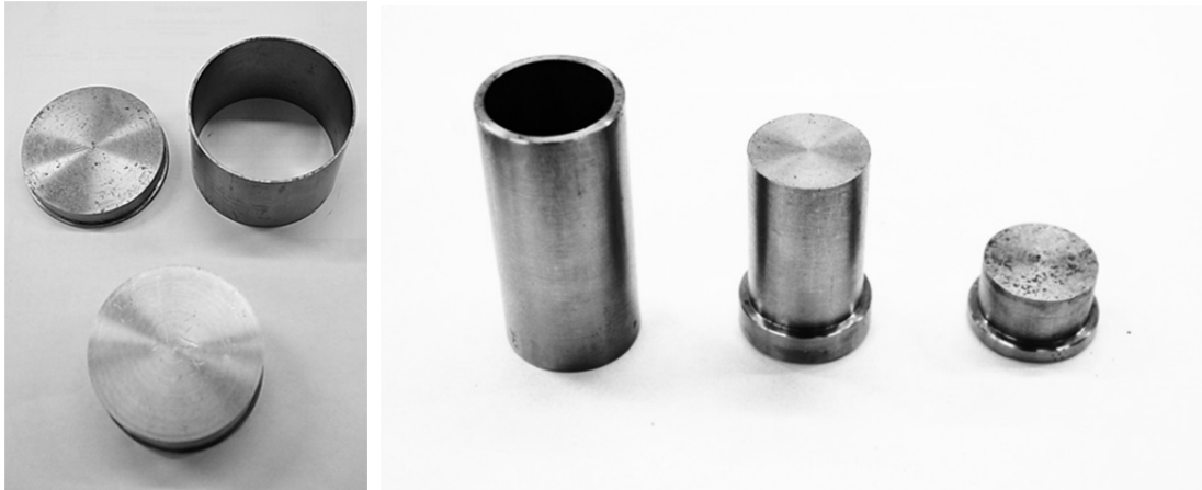
Figura 3.20.- Molde para probeta de 99 mm diámetro (izquierda) y de 29 mm diámetro (derecha).
