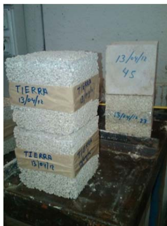
Figura 3.5- Muestras preparadas con una relación corcho/cemento blanco (5/1) y adición de aireante.
