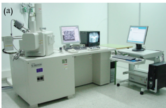
Figura 2.13 (a) Microscopio electrónico de barrido (SEM) empleado en la caracterización microestructural de los materiales con tamaño de grano submicrométrico o micrométrico y (b) microscopio electrónico de barrido de emisión de campo (FE-SEM) empleado en la caracterización microestructural de los materiales con tamaño de grano ultrafino o nanométrico.
