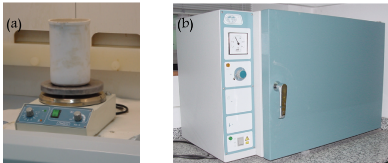
Figura 2.2 (a) Recipiente de teflón y placa calefactora empleados para la eliminación del etanol de las mezclas de polvos, y (b) estufa calefactora empleada para el secado de las mezclas de polvos.
