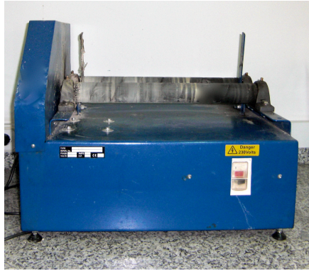
Figura 2.1. Molino de rodillos empleado para la homogeneización de las mezclas de polvos.
