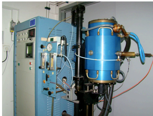
Figura 2.5. Horno de grafito de alta temperatura y atmósfera controlada utilizado para las sinterizaciones sin presión.
