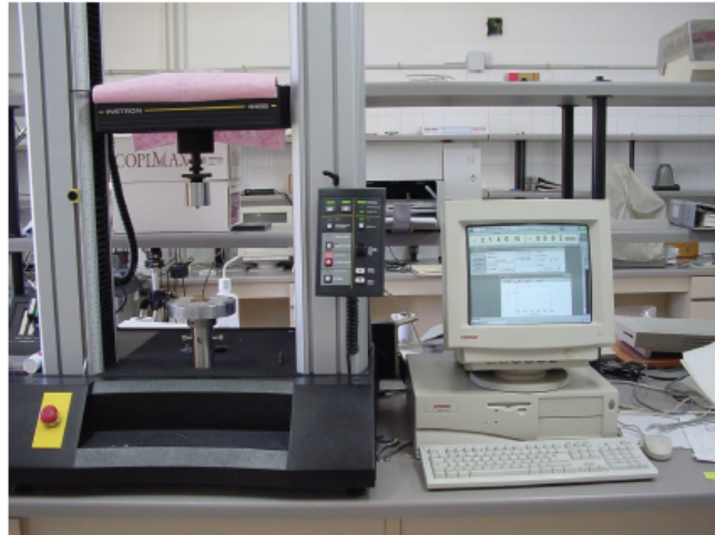
Figura 2.18. Máquina de ensayos universal empleada para obtener la curva tensión-deformación de indentación Hertz.
