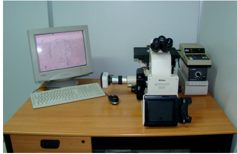
Figura 2.17. Microscopio óptico utilizado para capturar imágenes de las improntas residuales generadas mediante los ensayos de indentación Vickers, Hertz y de desgaste por deslizamiento lubricado.
