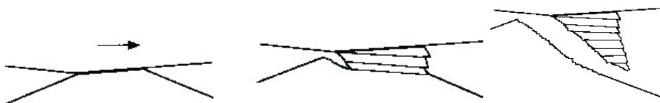
Figura 1.21. Representación esquemática del proceso de transferencia observado en el modo de desgaste adhesivo [16].
