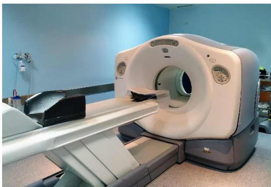
Figura 25. Sistema híbrido PET/TC Discovery ST4 (General Electric Healthcare) implantado en 2006 en el Complejo Hospitalario Universitario de Badajoz.
